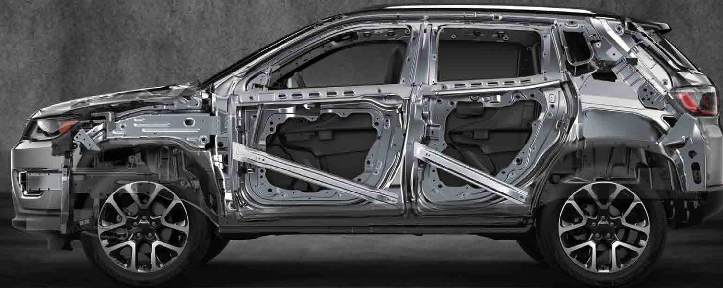
**CARROCERÍA DE ALTA RESISTENCIA** EL COMPASS OFRECE UNA TRANQUILIDAD EXCEPCIONAL CON EL CORAZÓN DE UN HÉROE: UNA SÓLIDA ESTRUCTURA DE UNA SOLA PIEZA CONSTRUIDA CON APROXIMADAMENTE UN 70% DE ACERO ESTAMPADO. ESTÁNDAR.
